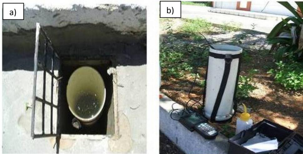
**Figura 2 – a) Amostrador simples instalado na sarjeta; b) Detalhe do amostrador no momento da amostragem.**
