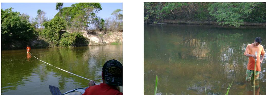
Figura 7 -a) Medição da largura b) Medição da profundidade
