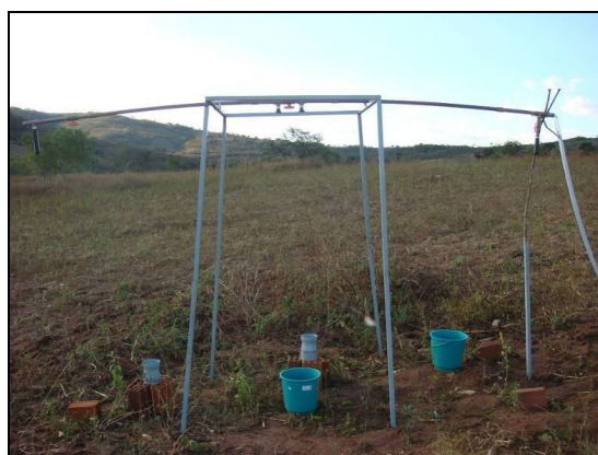
Figura 3 – Configuração utilizada durante o processo de calibração do simulador de chuva.
