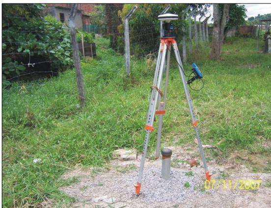
Figura 10 - Obtenção de coordenadas UTM, com uso de GPS geodésico.
