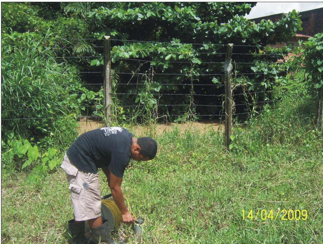
Figura 14 - Medição dos níveis potenciométricos, SP3.
