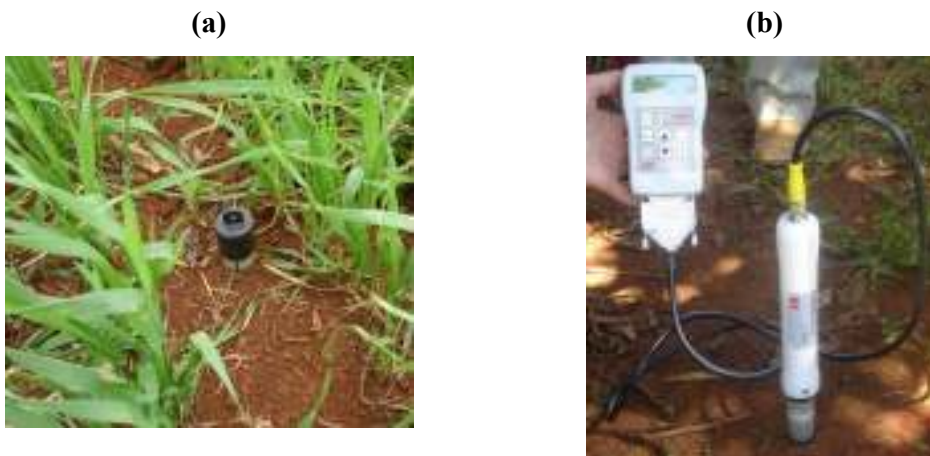
Figura 3 – Tubos de acesso para medida da umidade no solo (a) e sonda de perfil utilizada na medida da umidade (b).
