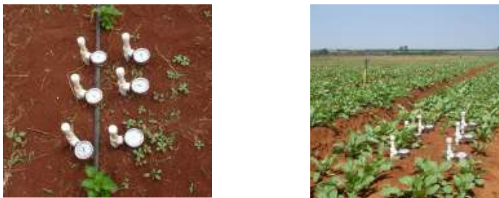
Figura 4 – Tensiômetros para o monitoramento da umidade do solo em áreas irrigadas.
