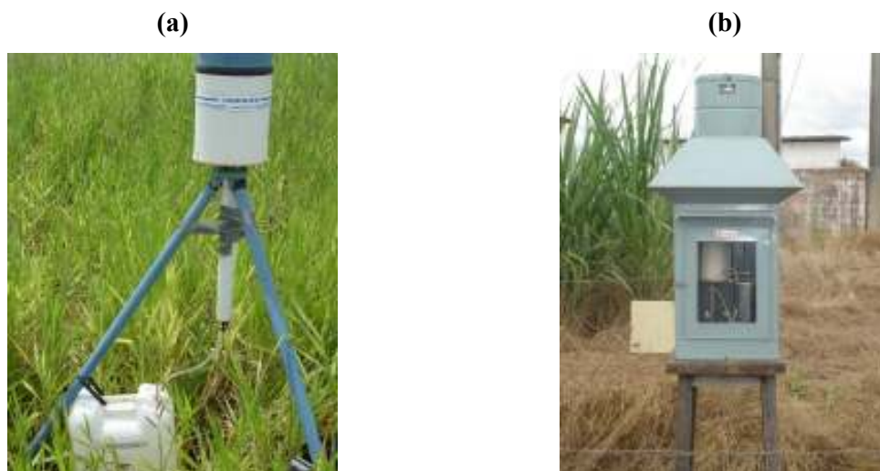
Figura 6 – Estrutura adaptada ao pluviômetro para coleta e armazenamento da água da chuva (a) e pluviôgrafo mecânico utilizado como referência na avaliação do pluviômetro da estação climatológica (b).
