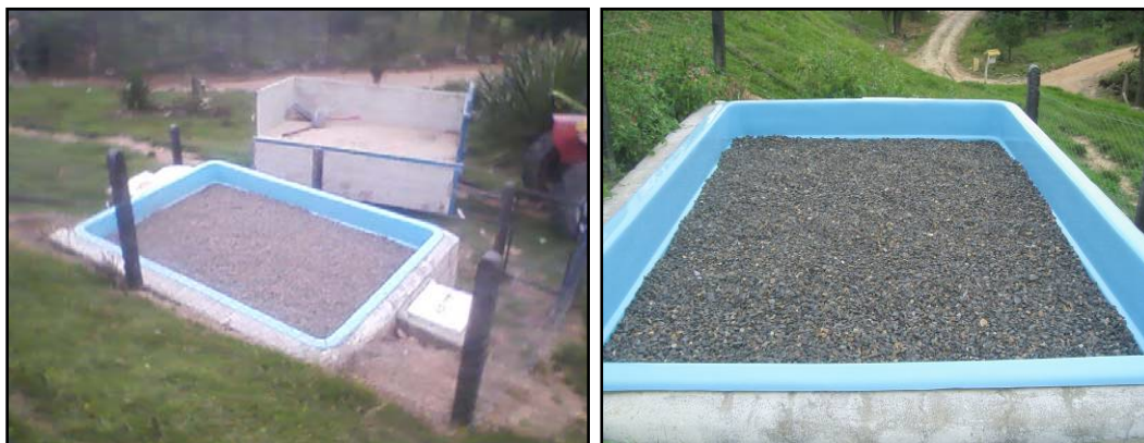
Figura 1a e 1b: Filtro de Pedras de fluxo ascendente, em escala piloto, da “Estação Experimental de Tratamento de Dejetos Suínos” – média propriedade.
