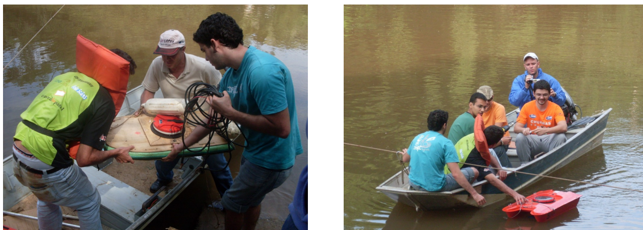
Figura 6 – Instalação do ADCP no barco e medição com o Qliner
