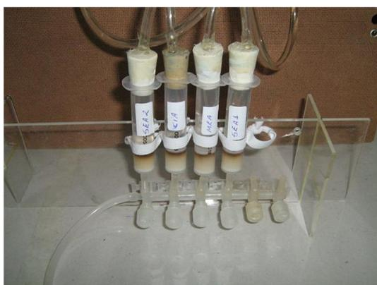
Figura 02 - Sistema utilizado para retenção dos estrogênios nos cartuchos C18.
