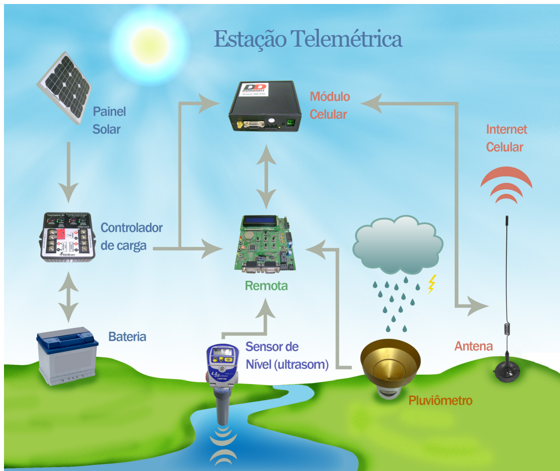
Figura 1 – Esquema da telemetria empregado pelo SAISP.
