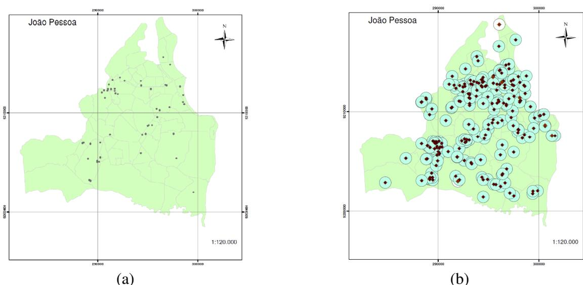
Figura 5 – Áreas de Influência dos poços com tempo de bombeamento de 4 horas (a) captação do aquífero Barreiras, muito pequena, imperceptível na escala do mapa; (b) captação do aquífero Beberibe.
