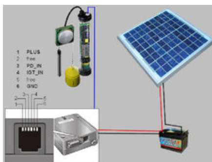
Figura 4 - Painel solar, bateria, thalimedes e modem.
