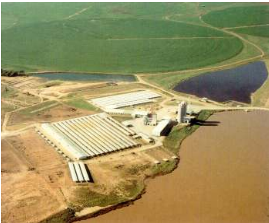
Figura 14- Aplicação de efluentes via sistema pivô central
