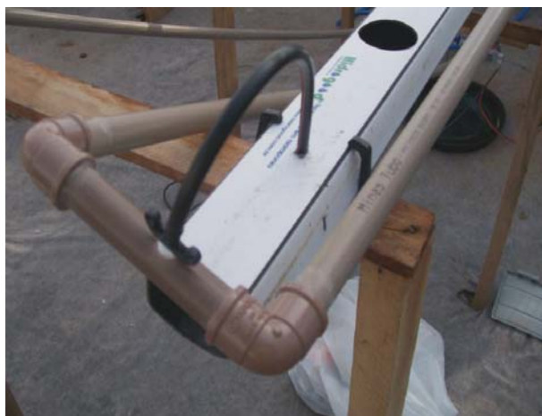
Figura 5 . Sistema injetor de solução nutritiva.
