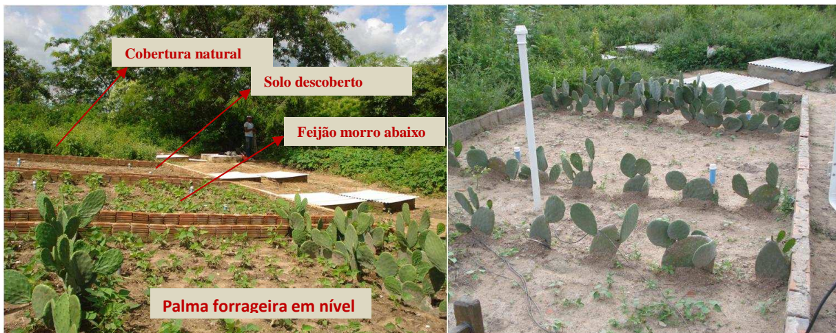
Figura 1- Detalhe das parcelas experimentais de erosão instaladas em campo.
