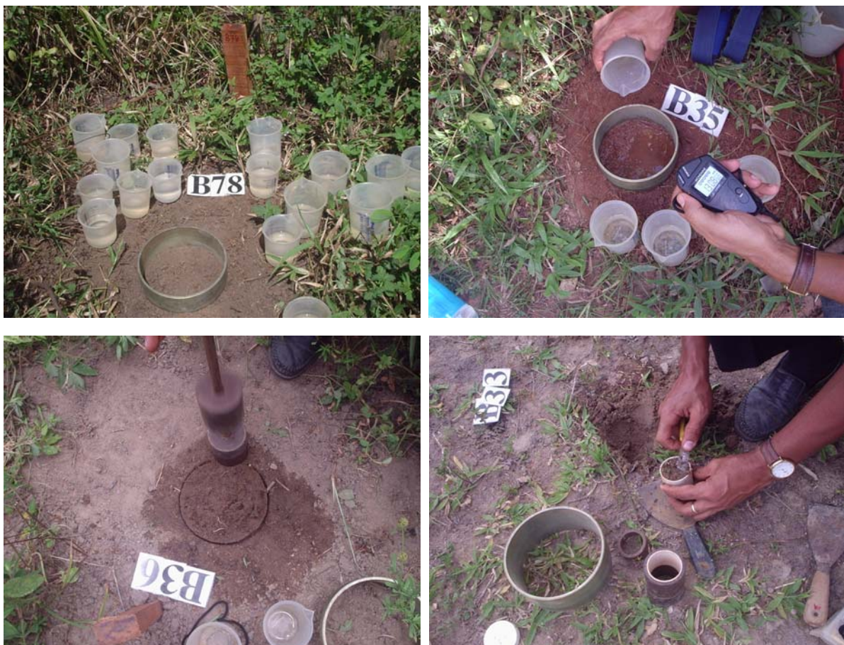
Figura 02. Teste de infiltração com anel simples na bacia experimental do riacho Gameleira – PE.
