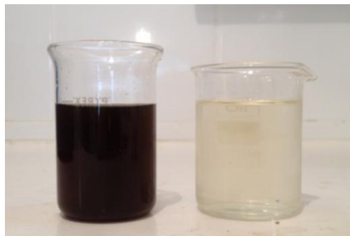
Figura 3. À direita lixiviado bruto e à esquerda lixiviado após o processo Fenton (ensaio 4)
