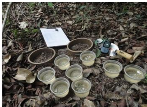
Figura 3 – Teste de infiltração tridimensional para a determinação da condutividade hidráulica da bacia
