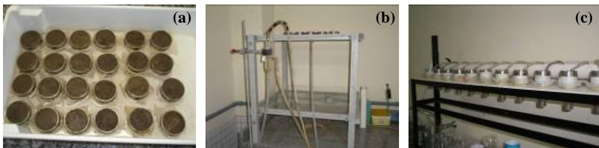
Figura 3. Amostras com estrutura preservada sendo saturadas (a), na mesa de tensão (b) e realizando a condutividade hidráulica da amostra saturada (c).
