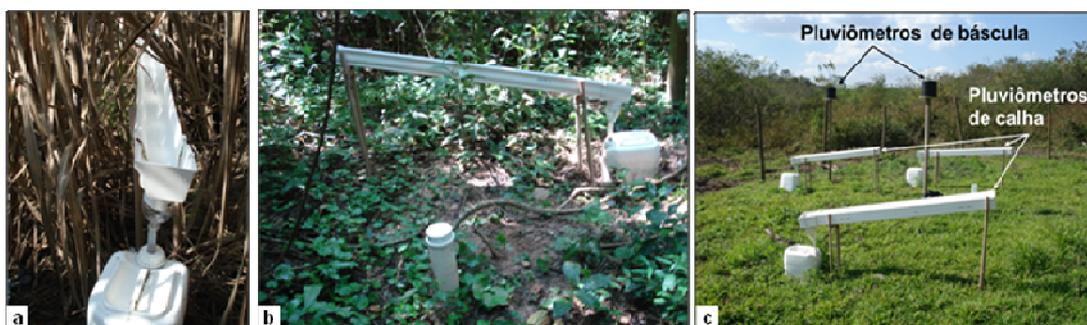
Figura 2 – a) pluviômetros de transprecipitação em cana-de-açúcar; b) pluviômetros de transprecipitação em floresta ripária; c) pluviômetros do tipo balsa "tipping-bucket" (Rain Wise) e pluviômetros de chuva.
