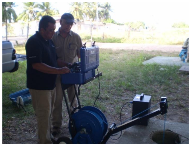
Figura 4 - Operação da perfilagem óptica em poço tubular profundo
