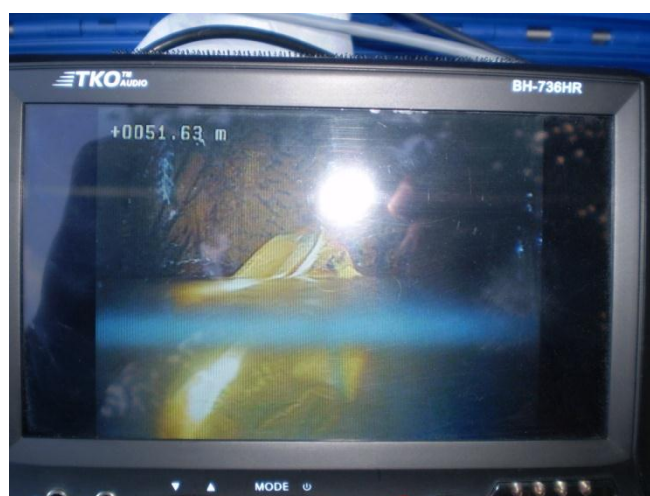
Figura 1 – Medição e imagem do nível estático obtida durante perfilagem óptica de poço.
