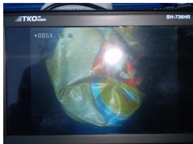
Figura 2- Imagem de lata de cerveja inserida de forma indevida ao poço verificada pelo perfilador óptico.
