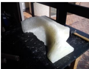
Figura 6 – Parede geradora da onda moldada em parafina
