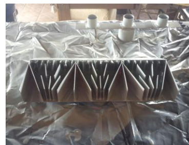
Figura 5: Difusor semi pronto recebendo acabamento em esmalte sintético
