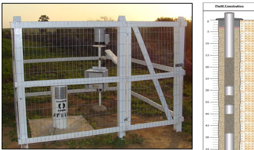
Figura 1. Foto de estação de monitoramento da RIMAS, composta de poço e estação pluviométrica automática. Ao lado perfil construtivo do poço localizado no aquífero Guarani, município de Alegrete/RS.
