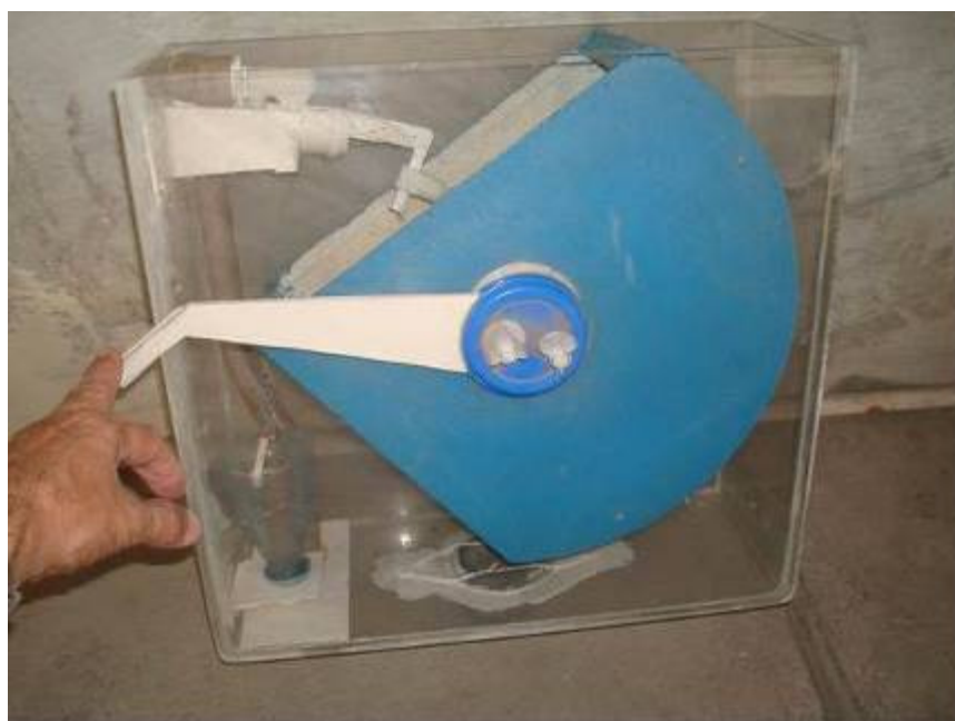
Figura 4 – Acionamento da caixa construída conforme especificações do primeiro projeto
