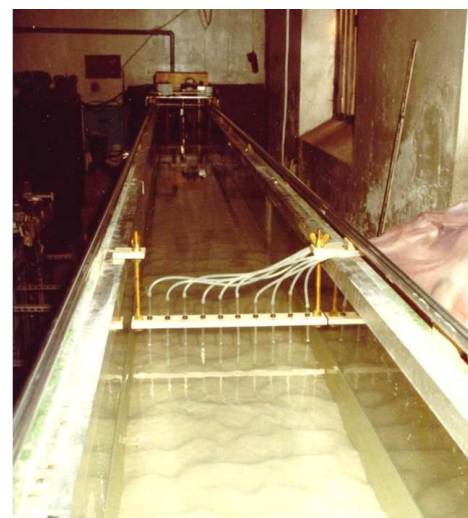
Figura 6- Imersão contínua de sedimentos na superfície livre. Canal do LCHF, França (Wilson-Jr., 1987)
