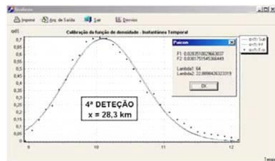
Figura 11- Curvas do tempo de passagem do corante, teórica e experimental, através da seção x = 28,3 km, no Rio Paraíba do Sul (Wilson-Jr e Monteiro, 2004).
