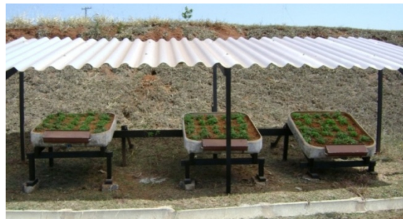
Figura 1 Vista Frontal dos módulos-pilotos de telhado verde logo após o plantio das mudas de Callisia repens com diferentes inclinações, correspondentes a 10, 20 e 30%, da esquerda para direita, respectivamente.
