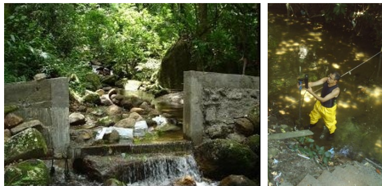
Figura 4 – Vertedouro na Seção fluviométrica do rio Sacarrão (à esquerda) e medição de vazão com FlowTracker no rio Morto (à direita).
