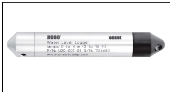
Figura 2: Sensor de nível de água modelo U20-001-01
