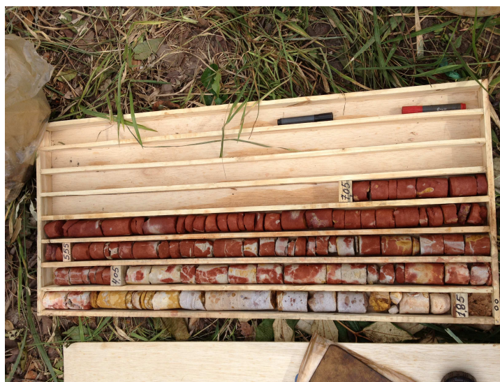
Figura 3 - Testemunhos de sondagem caracterizando passagem de arenito branco amarelado para arenito vermelho silicificado maciço, no Bairro Santo Fujão. Costa Rica – MS.
