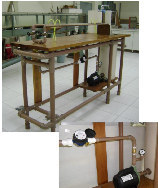
Figura 1- Vista lateral da bancada didática e em detalhe o sistema de bombeamento.
