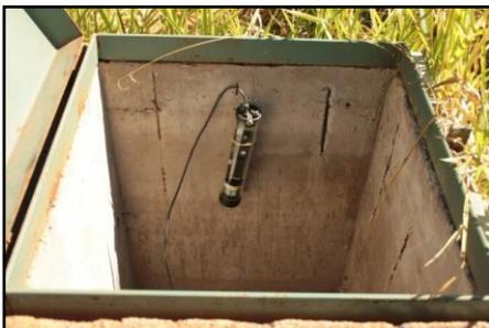
Figura 2 – Linígrafo instalado na sub-bacia do C.O.
