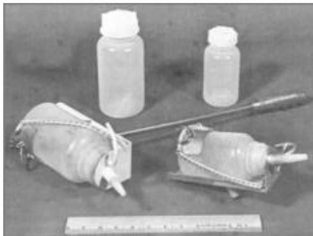
Figura 2 - Amostradores DH-75-P e DH-75-Q da esquerda para a direita, respectivamente.
