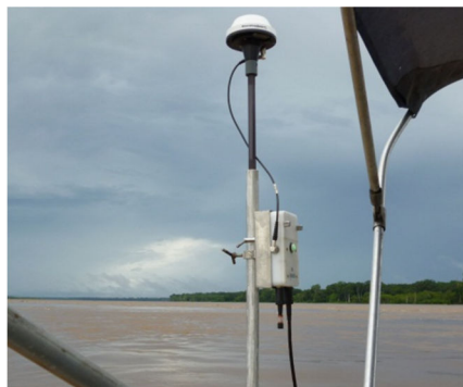
(b) DGPS – Instalado na embarcação.
