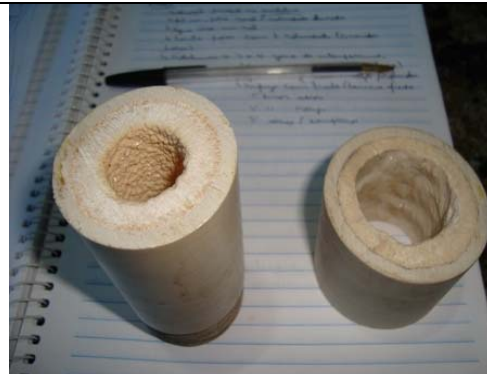
Figura 4 – Tubos edutores incrustados (Fonte: PROPOÇO).
