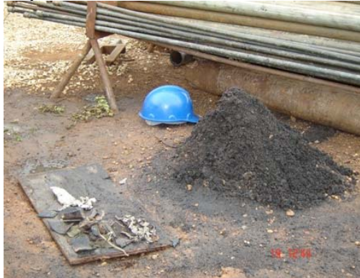
Figura 5 – Ferro incrustado retirado após uma reabilitação feita pela Propoço (Fonte: PROPOÇO).
