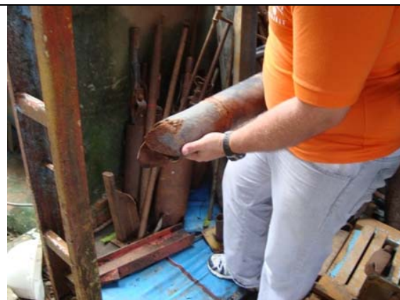
Figura 2 – Trado afiado nas pontas (Fonte: PROPOÇO)
