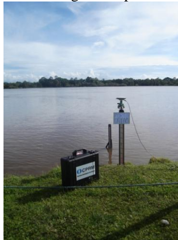
Figura 2- Ocupação de um lance de régua por receptor GPS para nivelamento da estação fluviométrica de Porto União.
