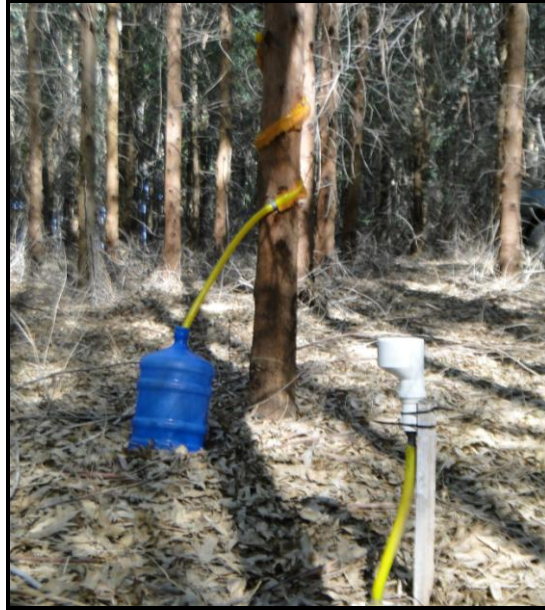
Figura 1 - Sistema coletor de água escoada pelo tronco das árvores de Eucalyptus urograndis .
