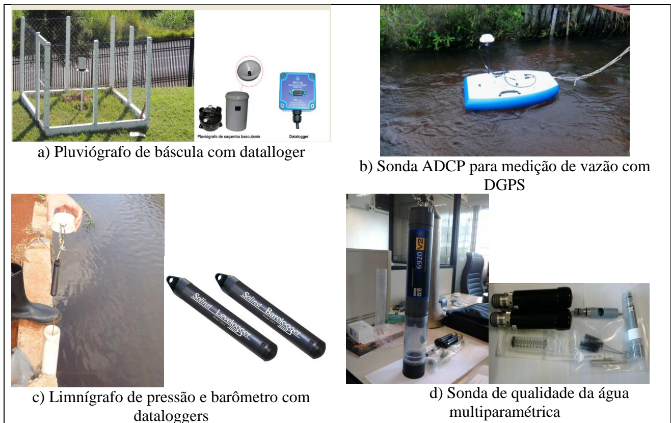
Figura 2: Equipamentos da rede de monitoramento hidrológica em São Carlos - SP
