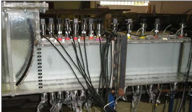
Figura 6 - Posicionamento dos transdutores de pressão utilizados nas medições.
