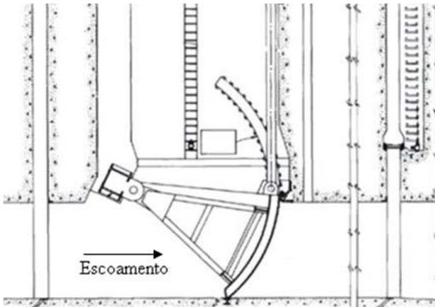
**Figura 1 - Comporta tipo segmento invertida – onde os braços radiais funcionam tracionados. (adaptada de UNITED STATES OF AMERICA, 1975).**
