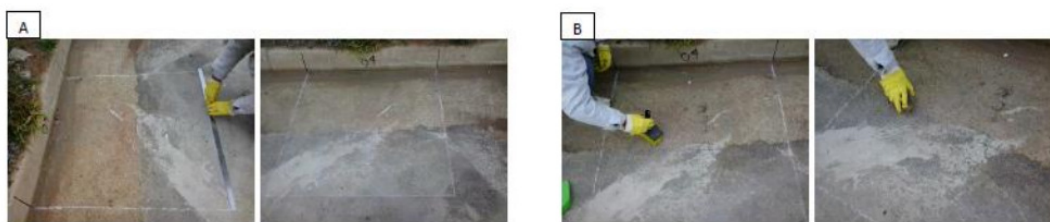
Figura 2 - Procedimento para demarcação das seções (A) e coleta de sedimentos por varrição a seco (B).
