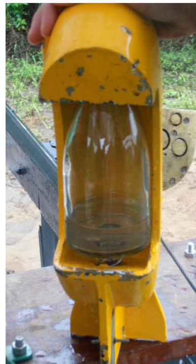
Figura 3 - Amostrador de sedimentos em suspensão do tipo USDH-59.
