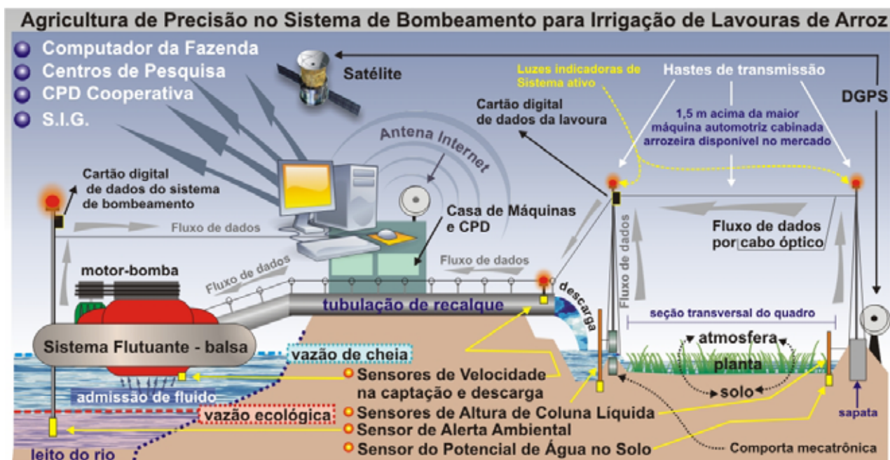
Figura 6 – Desenho esquemático de um sistema de bombeamento instrumentado e automatizado, interligado por cabo óptico ou rede wireless.
