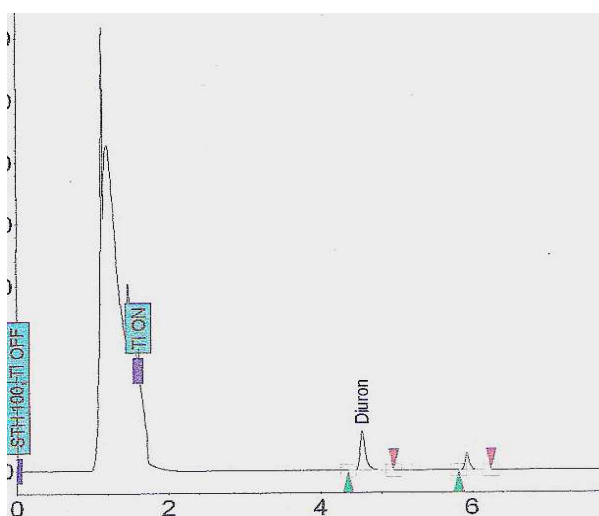
Figura 5 - Leitura do cromatógrafo gasoso referente à concentração 2,4 \text{ mg L}^{-1} da solução padrão
