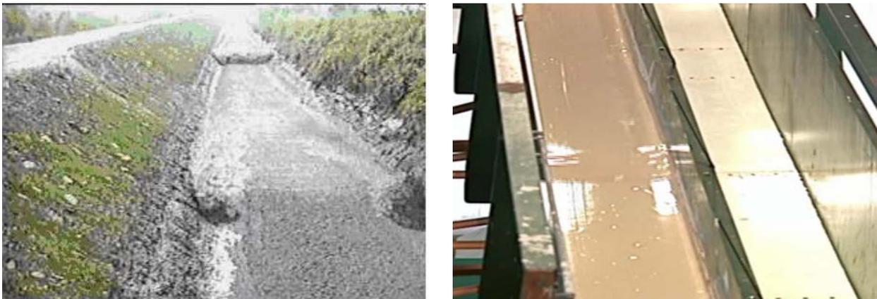
Figura 1- Visualização do fenômeno Roll Waves em escoamentos hiperconcentrados (esquerdo) e na rampa de lavas torrenciais da UNESP-Ilha Solteira (direito) respectivamente.
