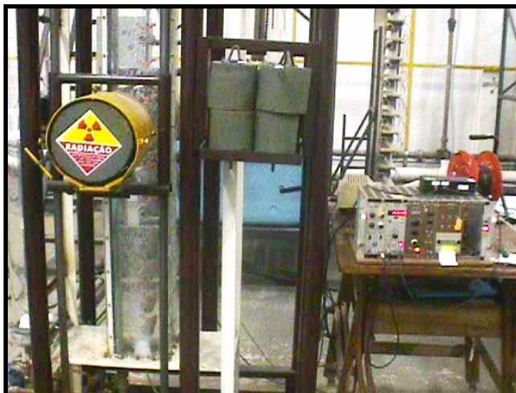
Figura 02 – Instalação experimental para ensaio com cézio-137 na coluna de ozonização com seção transversal quadrada. Englobam os mesmos equipamentos descritos na Figura 01.
