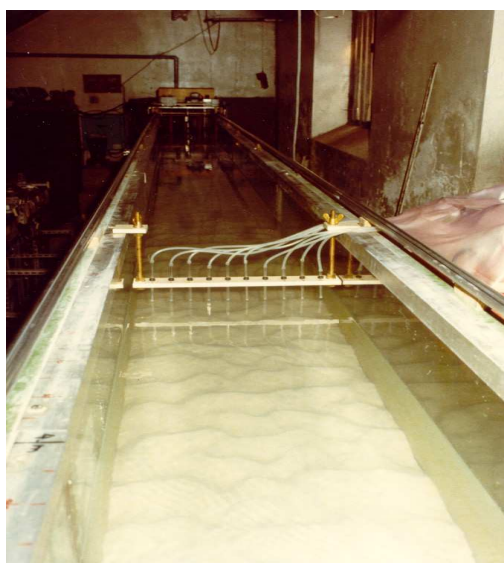
Figura 4 – Injeção contínua do sedimento na superfície livre do canal do LCHF (Wilson-Jr., 1987)
