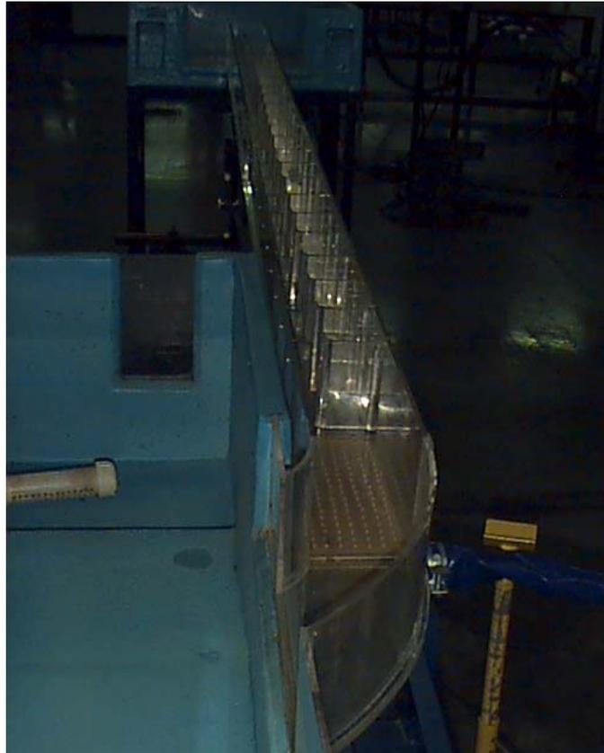
Figura 1 – modelo reduzido, escala 1:20, do MTP da UHE de Igarapava
