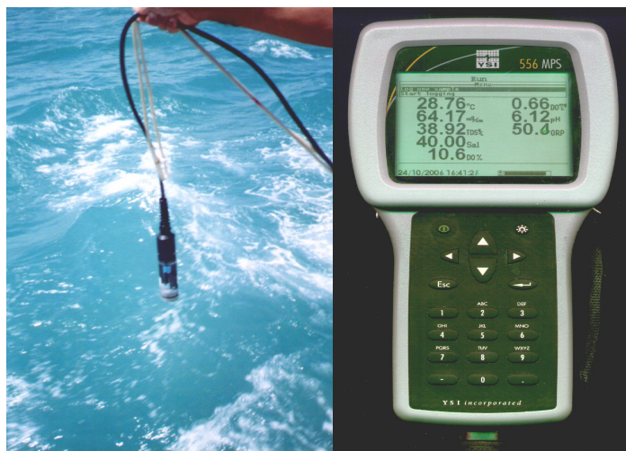
Figura 4 - Sonda multiparamétrica do tipo YSI – 556 MPS utilizada na medição dos parâmetros físico-químicos da água na área do SDOES, no desenvolvimento das três campanhas de monitoramento (maio/junho de 2006; agosto de 2006 e novembro de 2006)
