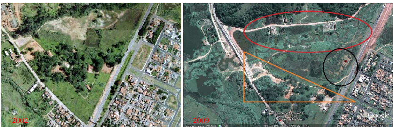
Figura 8 – Área degradada pelo desagüe urbano demarcadas em laranja e preto. Erosão fluvial marginal na área delimitada em vermelho na Bacia do Rio Jundiá – Mirim, SP.
