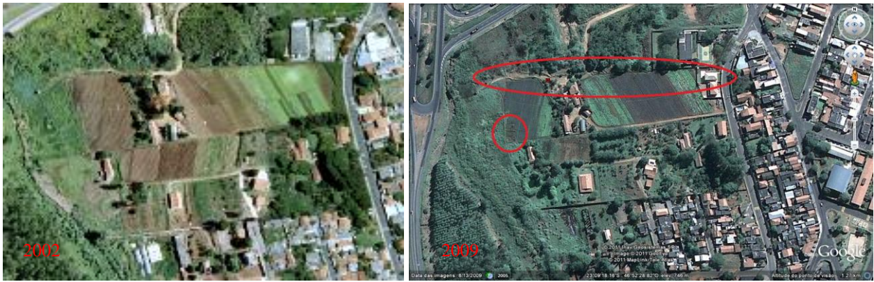
Figura 6 - Ponto de desagüe urbano com formação de sulcos de erosão (circundados em vermelho) entre 2002 e 2009 na Bacia do Rio Jundiá – Mirim, SP.
