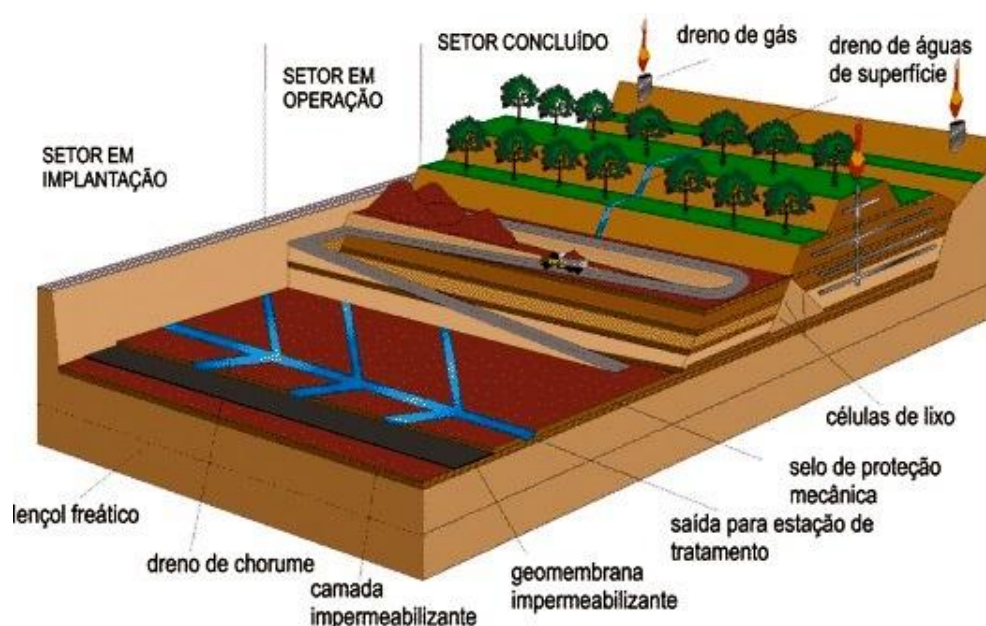
Figura 1: Diagrama esquemático de um aterro sanitário (Fonte: IPT/CEMPRE, 2000).
