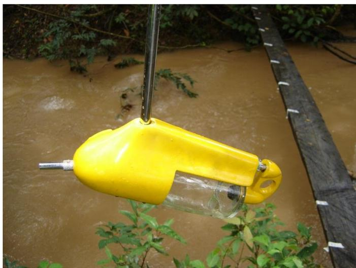
Figura 6 – Equipamento USDH 48 de coleta de amostra de água+sedimentos de forma integrada na vertical.
