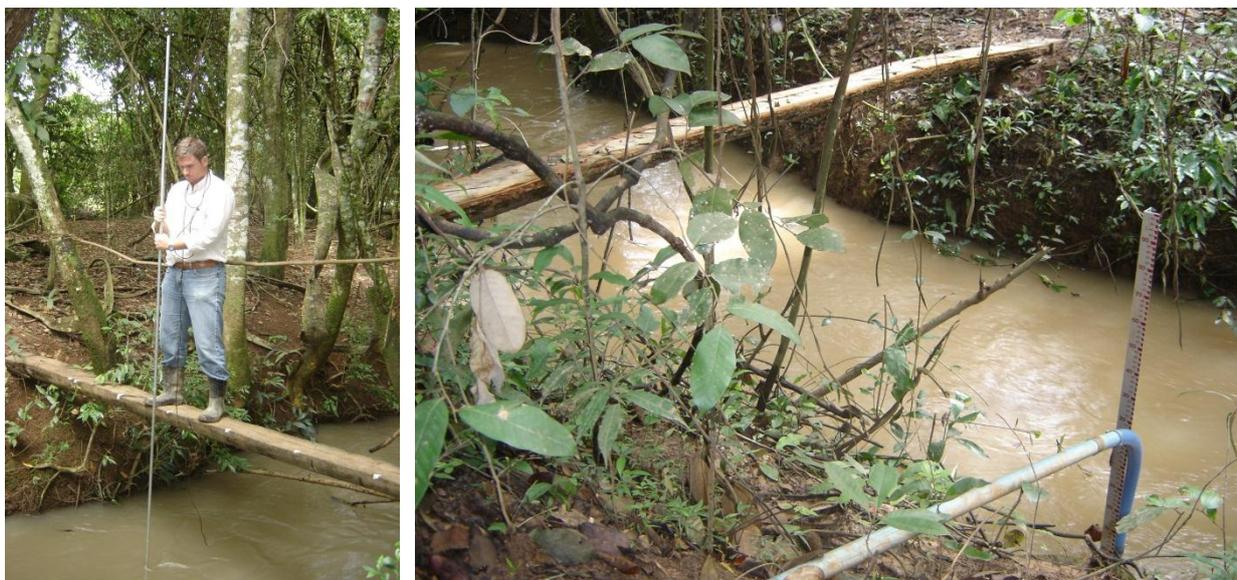
Figura 5 – Estrutura das estações fluviográficas da Bacia Experimental do Alto Rio Jardim.
