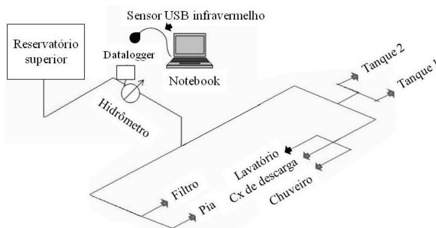
Figura 1- Esquema da instalação hidráulica na residência piloto
